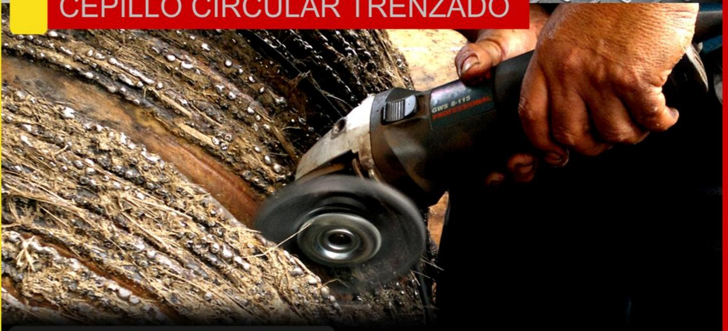
**P**roveen limpieza perfecta con gran capacidad de arranque, larga duración y facilitando la capacidad de trabajo en altas revoluciones. Ideal en áreas de difícil acceso por su especial diseño, muy recomendado para uniones de tubería, uniones tipo filete, y la eliminación total de escoria entre pases de soldadura. A su vez útil para la eliminación de escoria en piezas de forja, y procesos de rencauchado.
