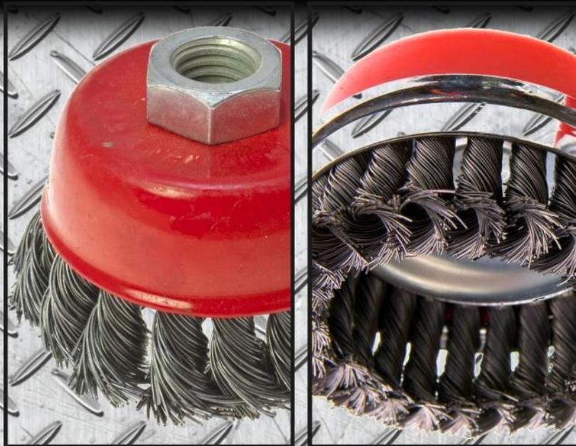
Estos cepillos se recomiendan para tareas de limpieza severa, en áreas planas y amplias, para eliminación de óxido o rebabas, preparación previo a trabajos de soldaduras especiales que requieren un área libre de contaminación además es sumamente recomendable usar entre pases para eliminar totalmente la escoria.
