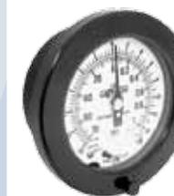
Los manómetros de 4 1/2" son fabricados en cajas de frente sólido, el movimiento esta montado sobre la conexión, la cuál está sujeta directamente a la caja impidiendo con esto que el instrumento se descalibre cuando el usuario lo instala apoyándose directamente en la caja. Son muy resistentes en condiciones ambientales severas y alta salinidad ya que están fabricados con acero inoxidable serie 300 (no magnéticos).
